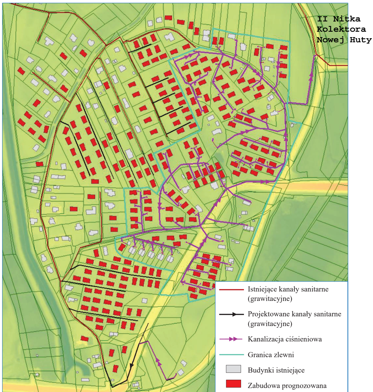
Ryc. 7. Planowany przebieg kanalizacji ciśnieniowej
